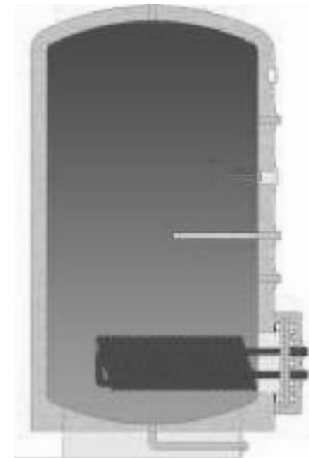
Fig. 21.- Acumulador con intercambiador de placas
